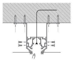
2. Просверлите монтажные отверстия и отверстия для ввода питания.
