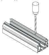
4. Закрепите шинопровод на поверхности потолка с помощью монтажных уголков и саморезов. Натяните полотно потолка и проклейте края гарпунов по всей длине шинопровода.
