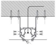
6. Заправьте гарпуны в пазы шинопровода и проклейте их. Шинопровод готов к эксплуатации.
